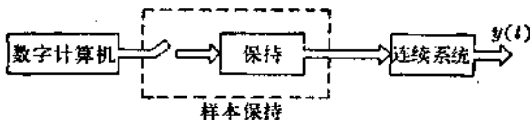
图 8.3-1 计算机控制的连续系统的方框图
